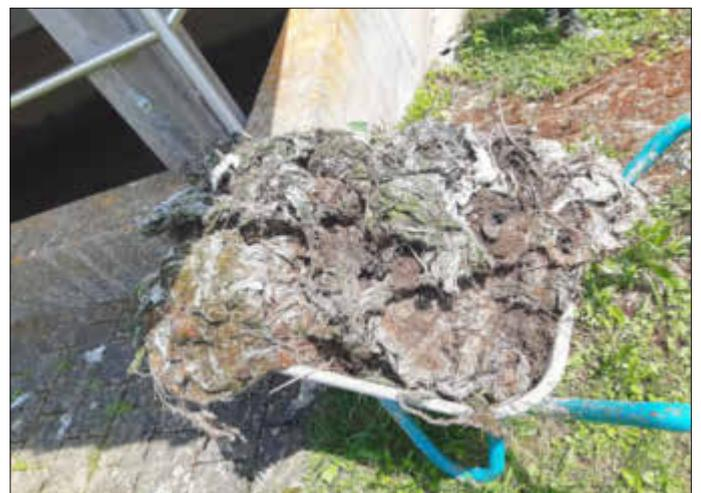
„gesammelte“ Feuchttücher aus dem Pumpwerk in Döckingen
